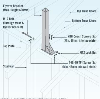
FIGURE 2.0 - FLYOVER ADJACENT TRUSS (OFFSET WALL STUDS)
